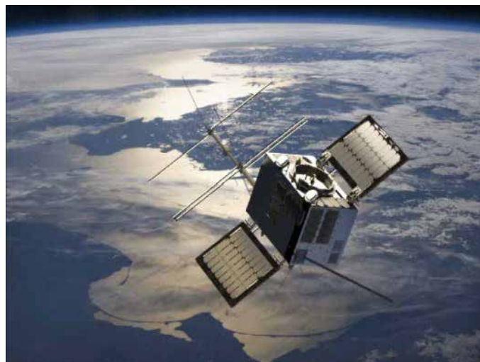
↑ NORSAT-TD: Norsk teknologidemonstrasjonssatellitt (NORSAT-TD) med norske og internasjonale nyttelaster for havovervåking og testing av alternative PNT-systemer (posisjon, navigasjon og tid). Skutt opp i 2022 og operativ fram til 2025.
